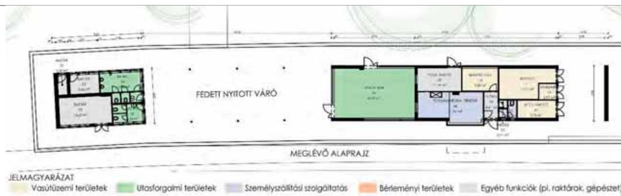
1.8. ábra: A meglévő állomásépület alaprajza és a fő funkciók (2. melléklet)
